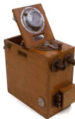
Tale Tx pesava 16 Kg ed era alimentato da accumulatori. Operava su una lunghezza d'onda compresa 100 e 200 metri, il circuito secondario era costituito dallo scricatore a scintilla collegato da un lato alla massa metallica dell'aereo e dall'altro lato con un filo conduttore lasciato pendere e della lunghezza di poche decine di metri.
